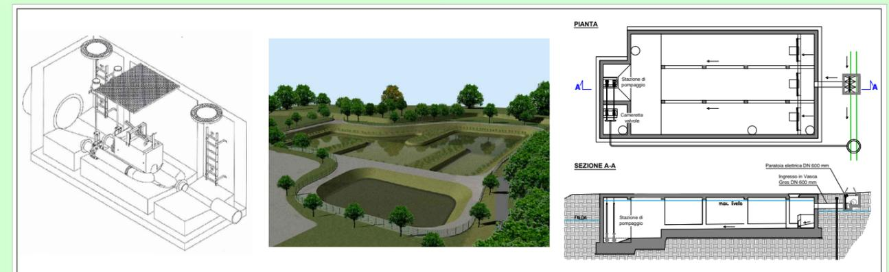
Fig. 9: Esempi delle diverse tipologie di intervento proposte per cercare di eliminare le criticità sul collettore
